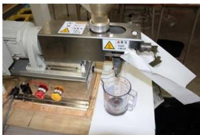
菜種を上部のジョウゴに投入すると、下のビーカーになたね油、右側からは菜種のしぼり滓が出てきます。
