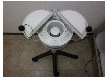
【食品放射能測定器】 ガンマ線スペクトロメーター LB-2045 (ベルトールド社製:独) NaI (TI) シンチレーション検出器
